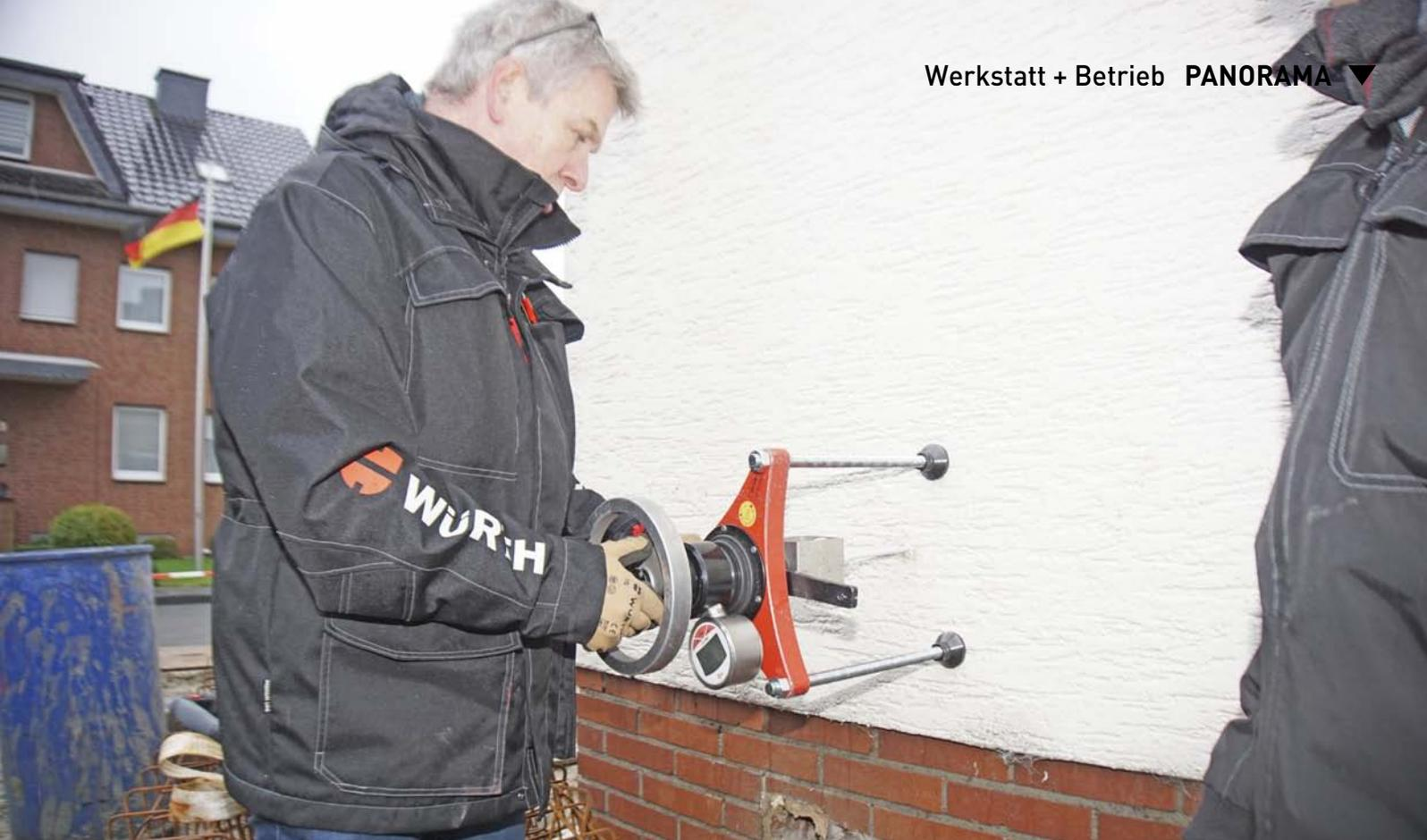
Testobjekt ist der Dämmstoffdübel W-DD-N aus dem Hause Würth, ein Schlagdübel mit Spreiznagel und einem 60 mm großen Teller in der Dimension 8 x 200, der für eine Dämmstoffdicke von 160 mm ausgelegt ist. Insgesamt werden auf der gesamten Wandfläche 15 Messwerte ermittelt. Die fünf schlechtesten Ergebnisse werden dann gemittelt und als Grundlage für die Beurteilung herangezogen.
